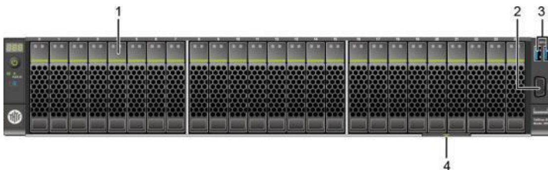
图 3-2 25x2.5英寸硬盘配置前面板组件
