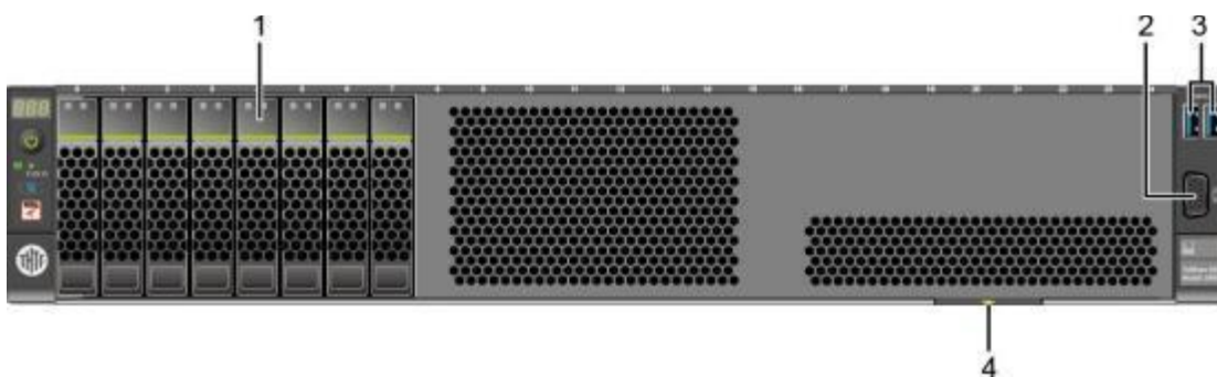
图 3-1 8x2.5英寸硬盘配置前面板组件
