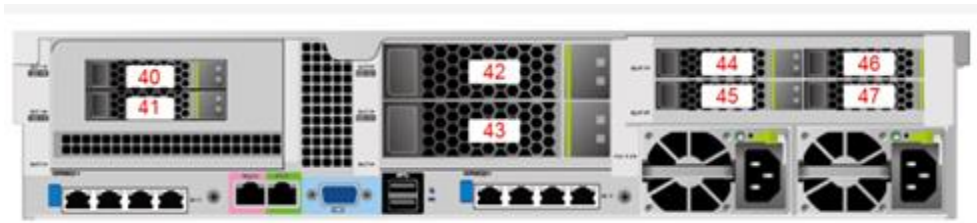
图5-7 后置背板硬盘编号
