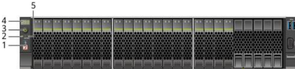
图 5-9: 24x2.5 SAS/SATA 直通硬盘配置前面板指示灯和按钮
