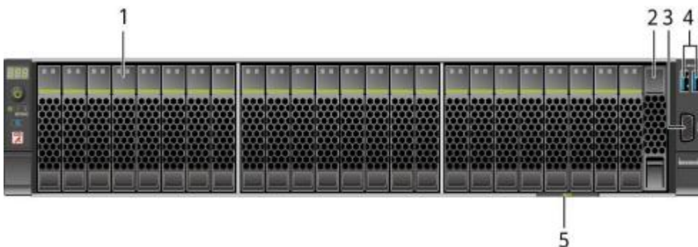
图 5-4：24x2.5 SAS/SATA 直通硬盘配置前面板组件
