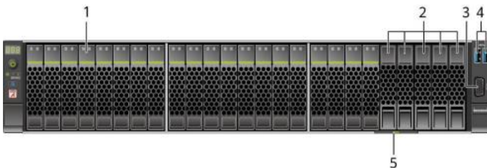
图 5-3：8x2.5 SAS/SATA+12x2.5 NVMe 硬盘配置前面板组件
