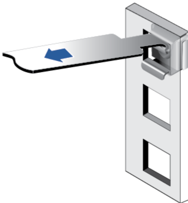
图6-4 在机柜中安装浮动螺母
