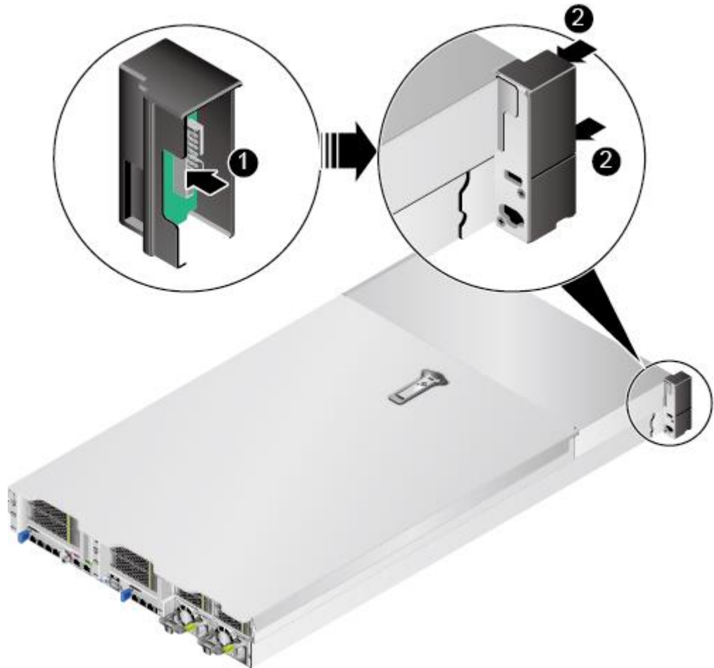
图6-91 安装左挂耳板
