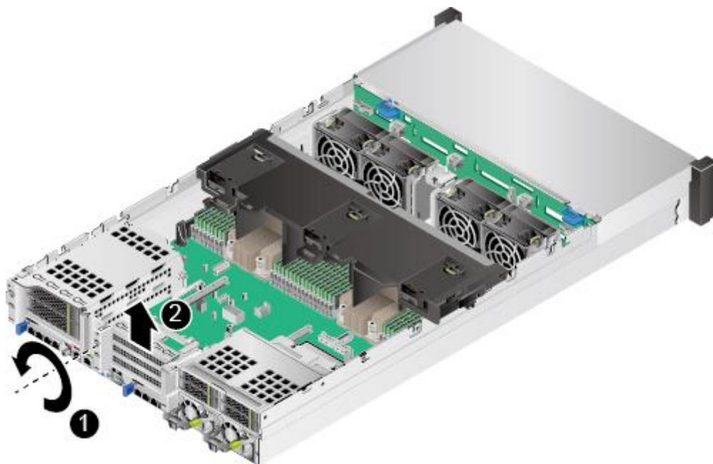
图6-49 拆卸空闲挡板 (2)
