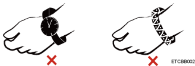
图1-2 去除易导电的物体
