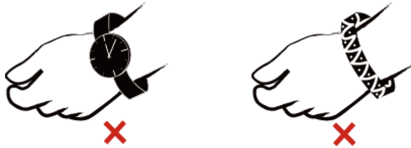
图6-1 去除易导电的物体
